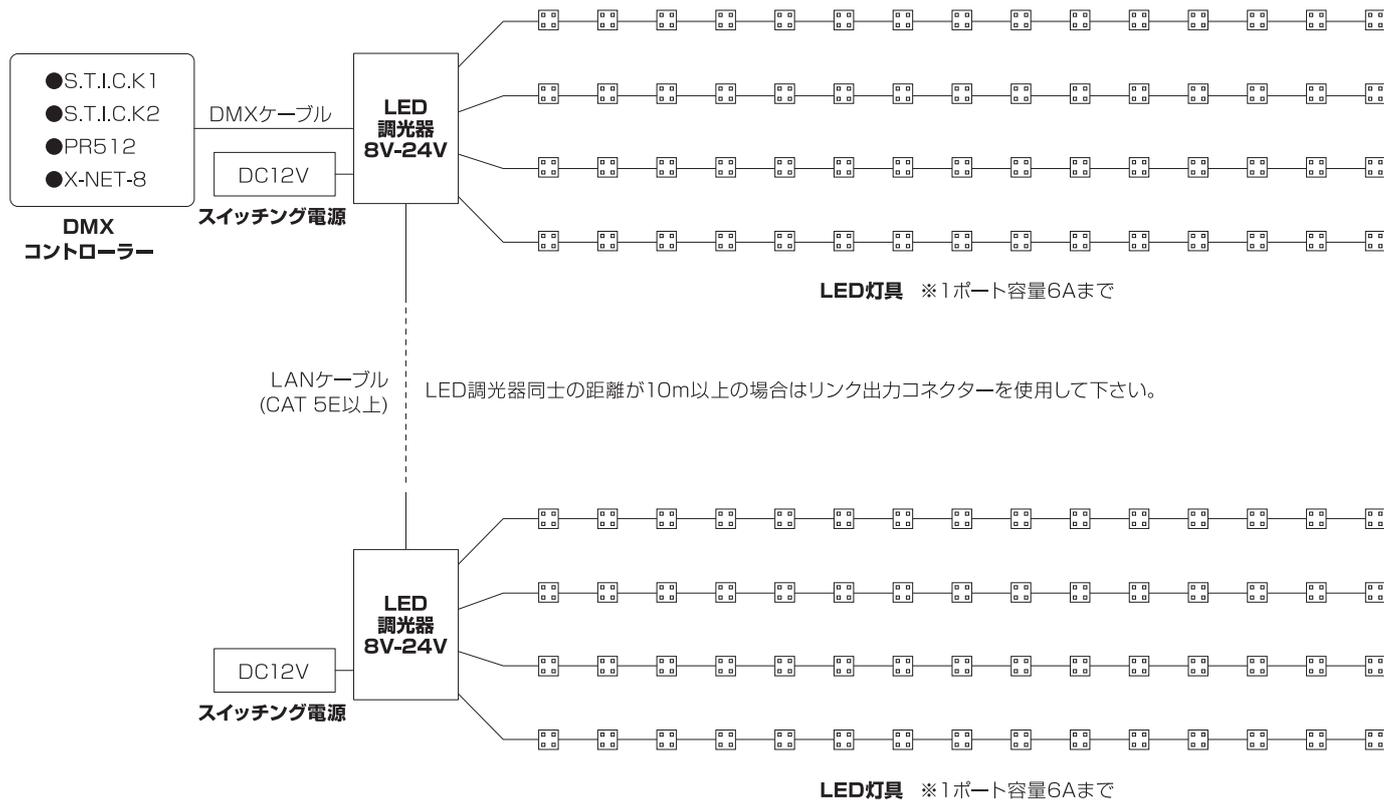
※使用する LED 灯具の電圧に合わせたスイッチング電源をご使用してください。
