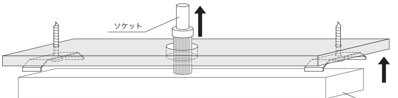
天井に開けた穴にソケットを通し、①で取り付けしたフレームホルダーに本体をはめ込んでください。
