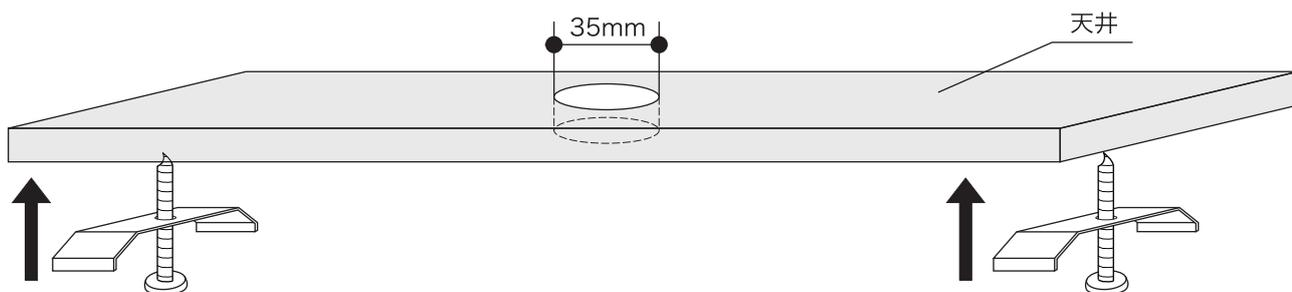
付属のフレームホルダーを天井にビス等で取り付けてください。(アンカーが必要な場合は別途アンカーを先に打設してください。)
