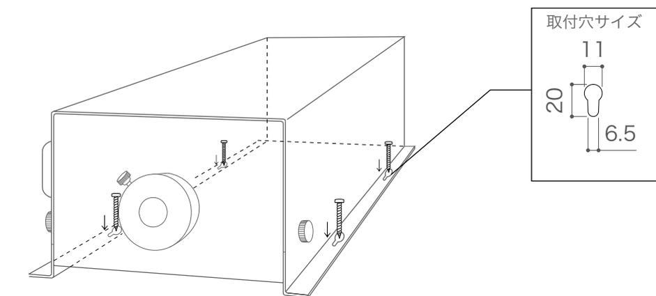
ライトエンジンの取付穴に合うネジ等を使用して設置面に固定してください。
