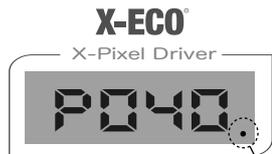
DMX信号を受信時、ディスプレイの※2の位置にマークが表示され自動的にDMXモードに切り替わります。
