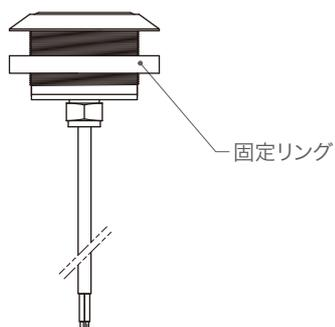
1. 付属の固定リングを配線から外して、図2のように取付板を固定リングを回して挟み込むように固定してください。
