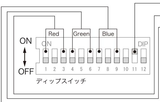
Dimming mode を使用する場合は、ディップスイッチ11をONにします。
