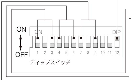
Bult in mode を使用する場合は、ディップスイッチ12をONにします。
