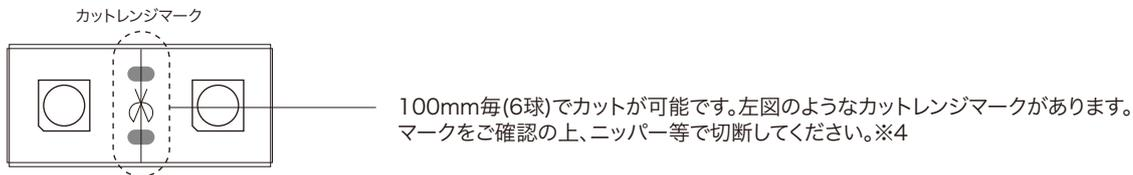
※4 切断した箇所はエンドキャップを使用し絶縁処理をしてください。
